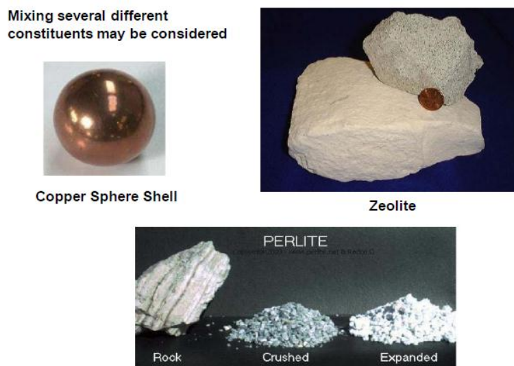
Figure 4: 格納容器は銅の球殻、ゼオライト、パーライトなどを、高い熱伝導率、放射線遮蔽能力、放射性物質・粒子の吸着能力を考慮して混合して詰める。
